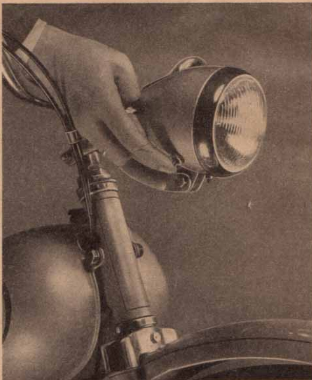
Bild 3 Kurzschlußknopf im Scheinwerfer
